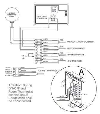
Şekil 27 Kazan oda termostatı ve dış hava sıcaklık sensörü bağlantıları.
